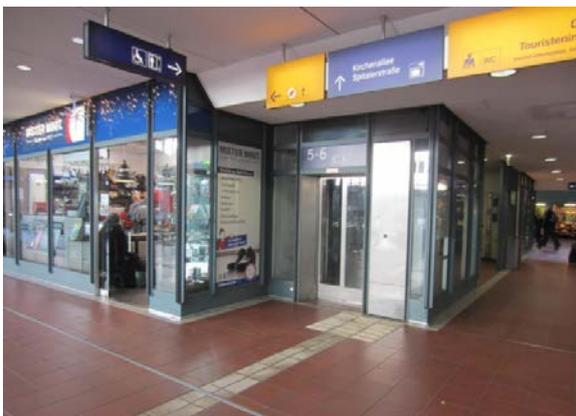
Der Aufzug ist für Sehbehinderte schwer auffindbar. Die Bodenplatten sind veraltet (profilarme Rille), das Aufmerksamkeitsfeld vor dem Aufzug ist falsch verlegt.
