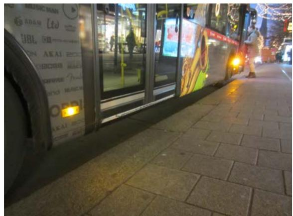
Eine geringe Kantsteinhöhe an Bushaltestellen ist für Rollstuhl- und Rollatornutzern problematisch, ein niedriger Bordstein führt zu steiler Rampenneigung
