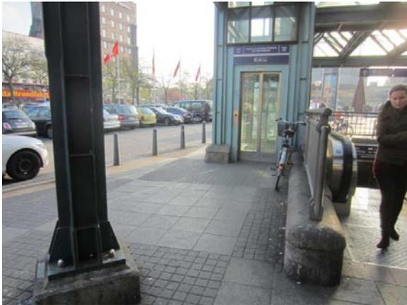
Angeschlossene Fahrräder an Treppengeländer (häufig zu beobachten) plus Säule vor dem Aufzug sind Barrieren für Menschen mit Rollstuhl, Rollator oder Kinderwagen. Derartige Engstellen sollten beim Bau vermieden werden.
